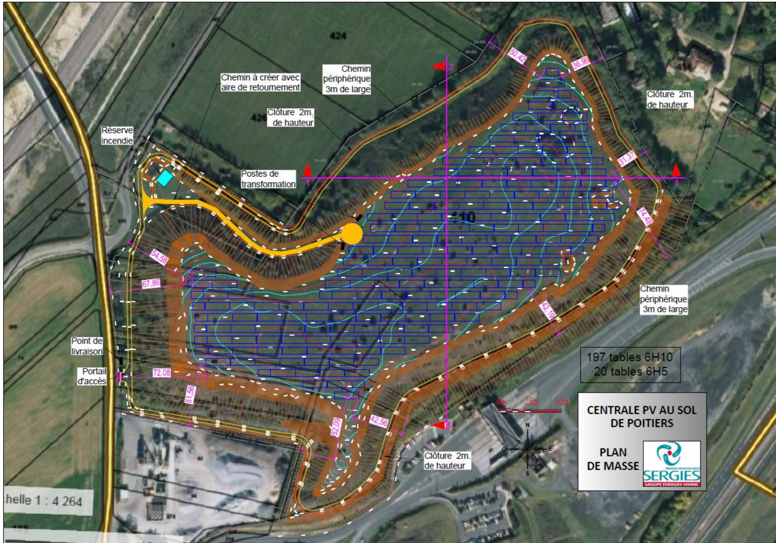
Figure 2 : Plan de masse du projet de centrale photovoltaïque de Chardonchamp (Source : SERGIES)
